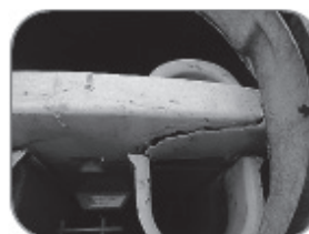
仕切板の亀裂
